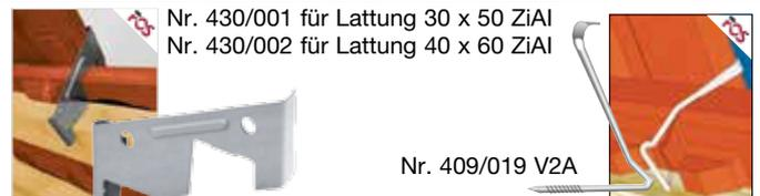
Entsprechend den Fachregeln liefern wir Sturmklammern für die einfache und effektive Windsogsicherung. Alternativ zum Verklemmen mit der Lattung oder zum Einschlagen in die Lattung. Korrosionsbeständig durch Edelstahlradht 1.4310 (A2) oder ZIAL®-Beschichtung (Korrosionsschutz).
