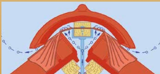
Bandbreite 360 mm (max. Unterdeckung)
