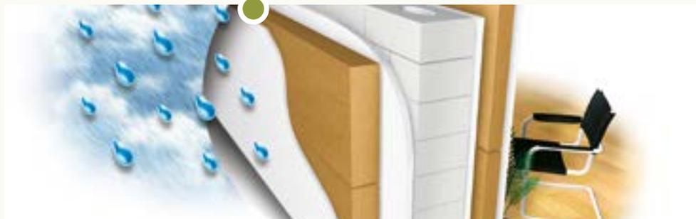
An Holzmassivwänden ist die Putzträgerplatte EnergiePlus massive vollflächig zu verlegen und mit Klammern oder Dämmstoffschrauben mechanisch zu befestigen. Am Mauerwerk wird die Putzträgerplatte EnergiePlus massive vollflächig verklebt und mit Dämmstoffdübeln mechanisch befestigt. Anschließend kann die gesamte Fläche mit Grundputz (inkl. Armierungsgewebe) und Oberputz verputzt werden.
