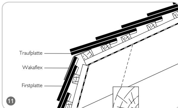
Bei der Ausbildung des Mansardknicks mit Opal Biberschwanzziegeln erfolgt der Abschluss der unteren Dachfläche mit Firstplatten oder einem Kronengebäude. Die Dachdeckung der oberen Dachfläche beginnt wie an der Traufe mit Traufplatten. Je nach örtlichen Gegebenheiten kann der Übergang der Dachflächen z. B. mit Wakaflex hergestellt werden. Die Lattmaße für die letzte untere und erste obere Dachziegelreihe sind individuell auf das Detail abzustimmen.
