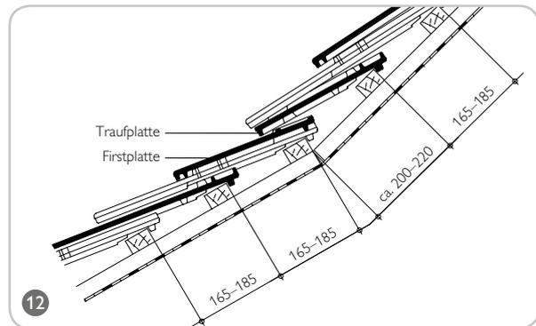
Die Dachdeckung der unteren Dachfläche endet mit Firstplatten. Die darüber liegende Dachdeckung beginnt wie an der Traufe mit Traufplatten. Die angegebenen Lattmaße dienen der Orientierung und sind unter Berücksichtigung ausreichender Höhenüberdeckung individuell auf das Detail abzustimmen. Zusätzliche Sicherheit kann vor allem bei größeren Dachneigungsunterschieden z. B. durch einen Streifen Wakaflex unter der Traufplattenreihe erzielt werden.
