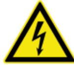
Dieses Symbol wird verwendet, wenn eine Gefahr des Kontaktes mit elektrischer Spannung besteht.
