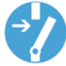
Dieses Symbol wird verwendet, wenn Sie elektrische Komponenten freischalten müssen, um Kontakt mit elektrischer Spannung zu vermeiden.
