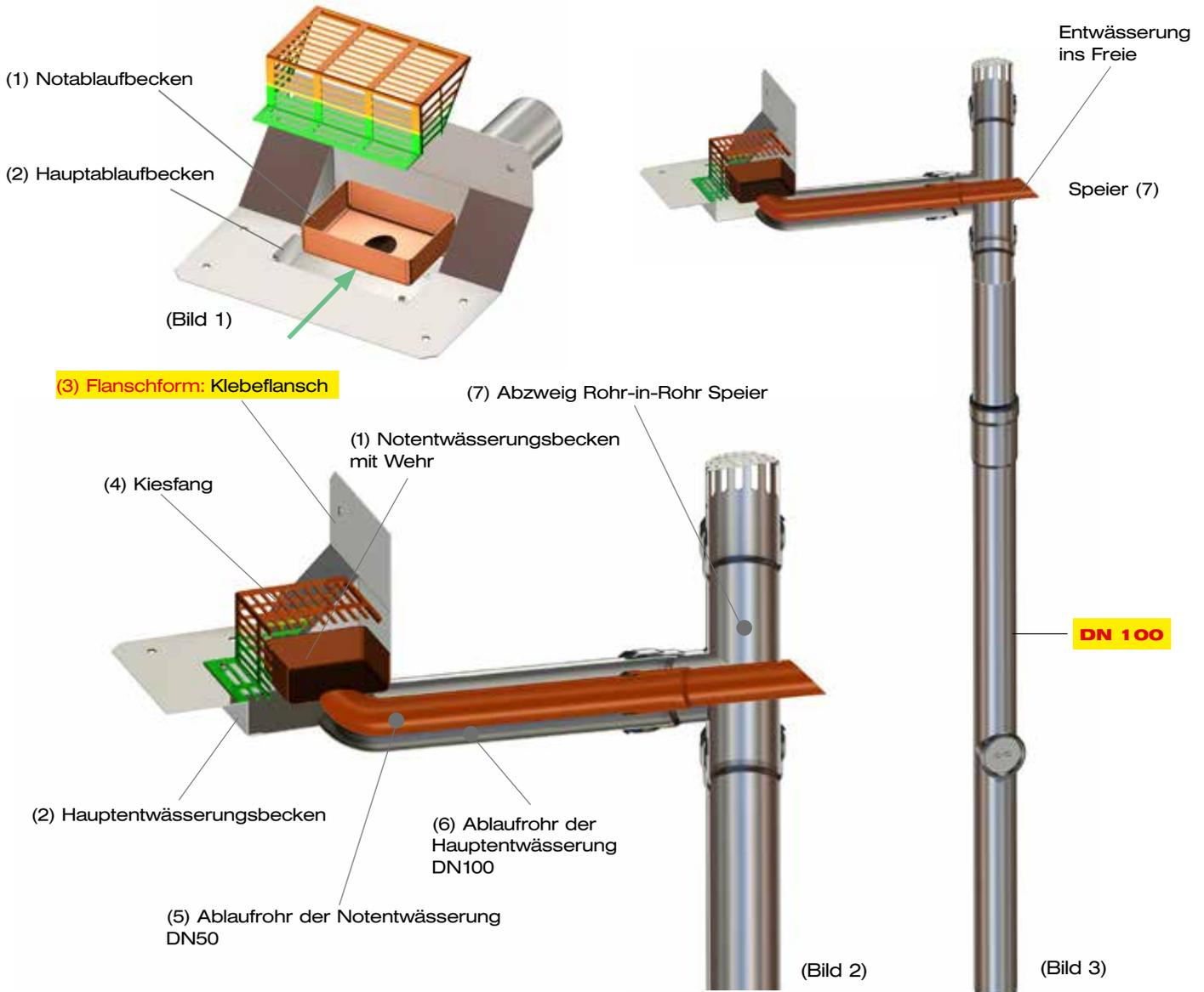
Im Attikaablauf ist über dem Becken für die Hauptentwässerung (2) ein Becken für die Notentwässerung (1) angeordnet. (Bild 1).
