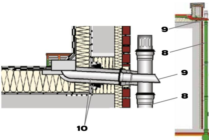
Geringer Platzbedarf durch Außenentwässerung des Attikadaches ohne Rohre im Gebäude.
