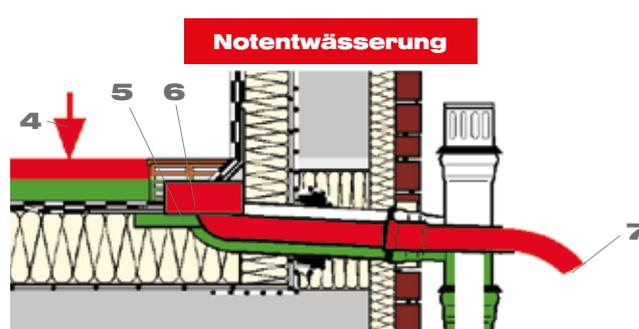
Geringe Wasserhöhe und großer Abfluss bei der Notentwässerung (4) durch das Notablaufbecken, das gegenüber dem Hauptablaufbecken höher gelegt ist (5).
