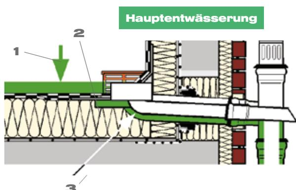
Geringe Wasserhöhe und hohen Abfluss (1) bei der Hauptentwässerung mit Freispiegelströmung durch ein Hauptablaufbecken (2) und ein tiefergelegtes Rohr (3).
