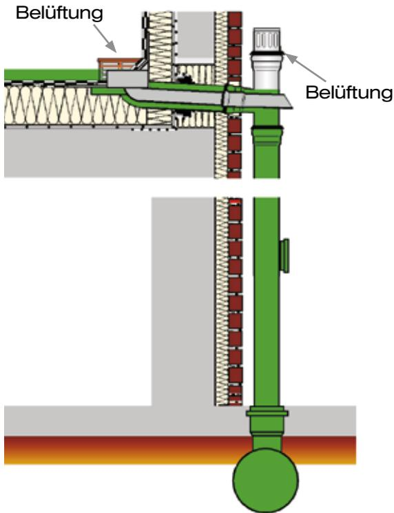
Ruhige Entwässerung des Attikadaches durch belüftete Freispiegelströmung der Hauptentwässerung. Optimal für Wohnungsbau.
