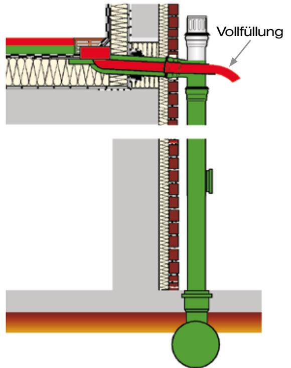
Sicherer Schutz des Attikadaches gegen zu große Wassermasse auf dem Dach mittels einer Notentwässerung mit separatem Fließweg als Speier ins Freie.
