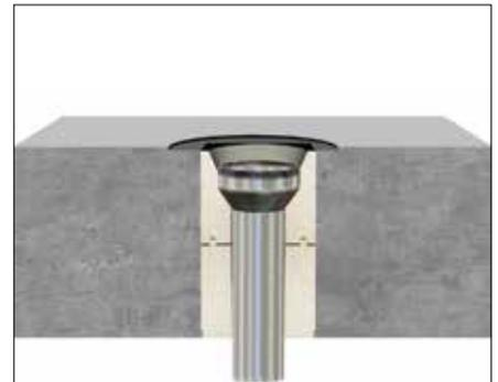
Schalungspilz und Schalung entfernen und Grundkörper Serie V in eingebauten Wärmedämmkörper einsetzen. Wärmedämmter Grundkörper fertig für weiteren Balkonaufbau und weiterführende Leitung.
