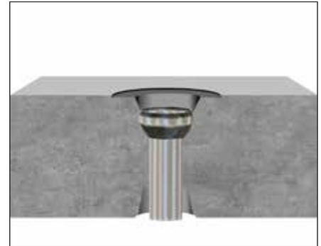
Schalungspilz und Schalung entfernen. Eingebauter ungedämmter Grundkörper fertig für weiteren Balkonaufbau und weiterführende Leitung.
