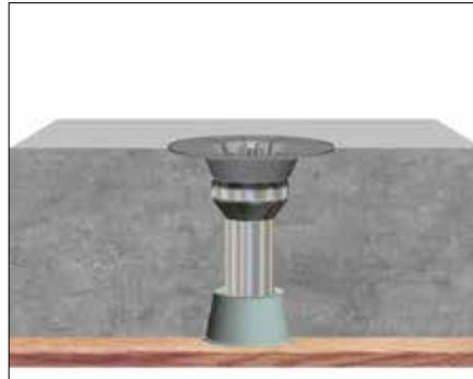
Grundkörper mit Schalungspilz\* und Schalungsglocke am Durchführungspunkt auf der Schalung verschrauben\*\*. Balkonplatte gießen. Zur leichteren Demontage wird empfohlen, die Schalungsglocke mit Schalungsöl zu benetzen.
