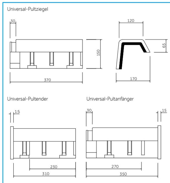
Der Universal-Pultziegel ist die systemgerechte Detaillösung für den oberen Abschluss des Pultdaches, mit einem Bedarf von drei Stück pro Meter. Ein kurzer Schenkel reicht bis auf die Flächen- oder Firstanschlussziegel und ein langer Lappen schließt das Dach an der Außenwand ab. Wie ein First wird dieser Formziegel mit Firstklammern auf einer Latte sicher befestigt. Ein Pultanfänger und ein Pultender machen den keramischen Pultabschluss komplett.
