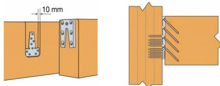
Die ETB-Passverbinder eignen sich sowohl für Hauptträger-Nebenträgeranschlüsse als auch für Stützen-Nebenträgeranschlüsse.
