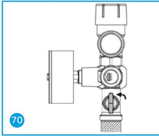
4. Öffnen Sie den Kugelhahn an der Sicherheitsgruppe mit einer 90°-Drehung nach links (senkrechte Position (Bild 70)).
