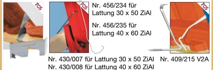
Entsprechend den Fachregeln liefern wir Sturmklammern für die einfache und effektive Windsogsicherung. Alternativ zum Verkleben mit der Lattung oder zum Einschlagen in die Lattung, Korrosionsbeständig durch Edelstahlendraht 1.4310 (A2) oder ZIAL®-Beschichtung (Korrosionsschutz).
