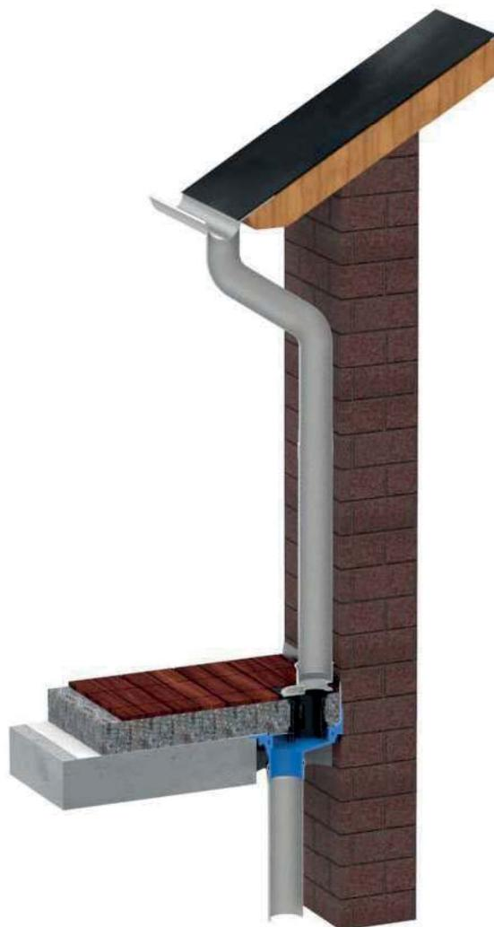
Exzenter-Gully mit Terrassenbausatz und Siebringaufsatz zur Aufnahme eines Fallrohres zur Weiterleitung des Regenwassers. Eingebaut auf Balkonfläche mit Terrassenbelag im Splittbett.
