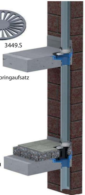
Falleitung so ausführen, dass diese für Wartungszwecke leicht zu demontieren ist, bspw. mit einem Schiebestück o.ä. in der Falleitung.
