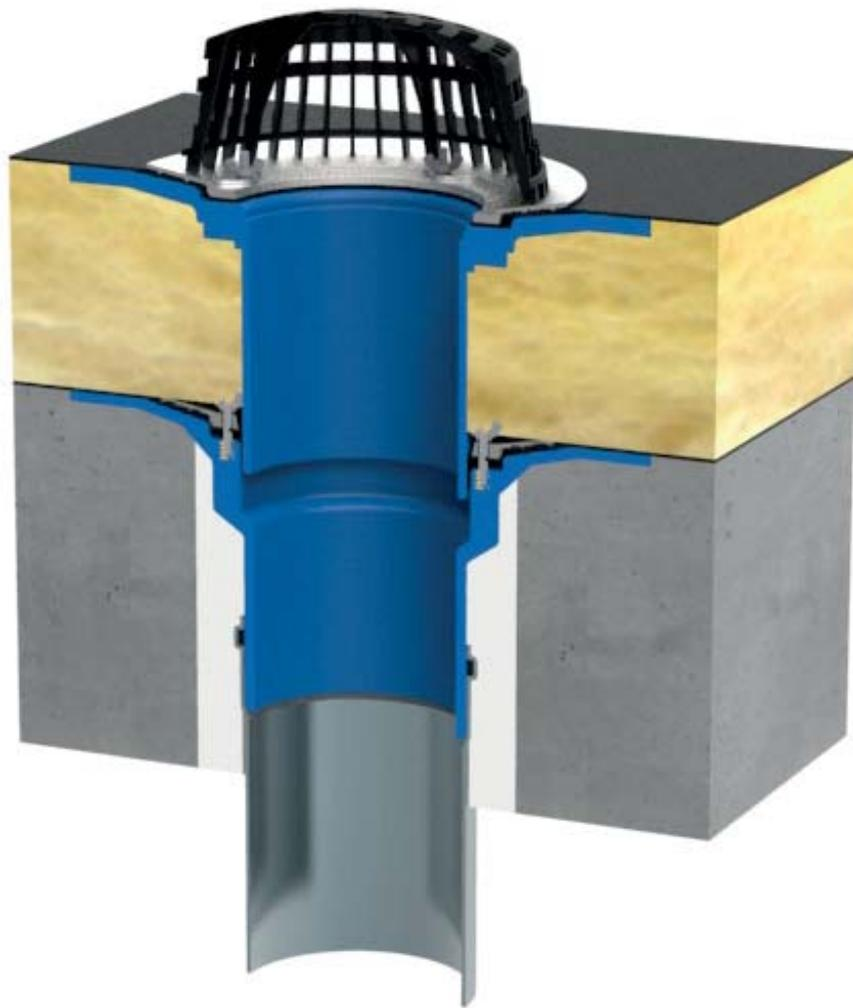
Klemmflansch-Gully DN 150 in Betondecke und ausgeschäumter Ausparung mit Aufstockelement im Warmdach verbaut.
